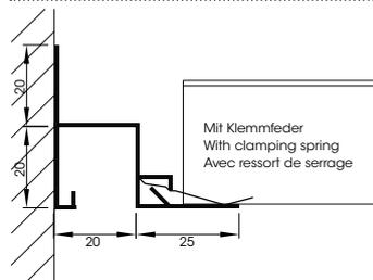
**Doppelrandwinkel mit Bilderschiene**
